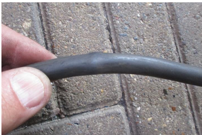
Afbeelding: beschadigde kabels van de kabelhaspel.
