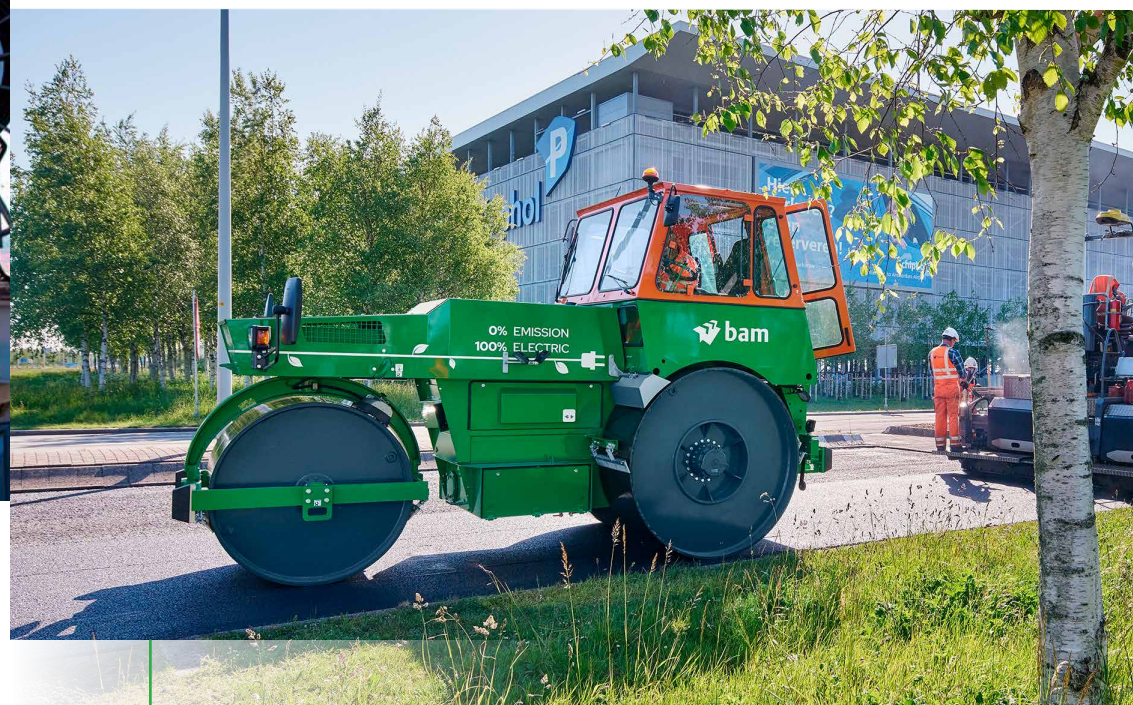
's Werelds eerste elektrische wals door BAM Infra
